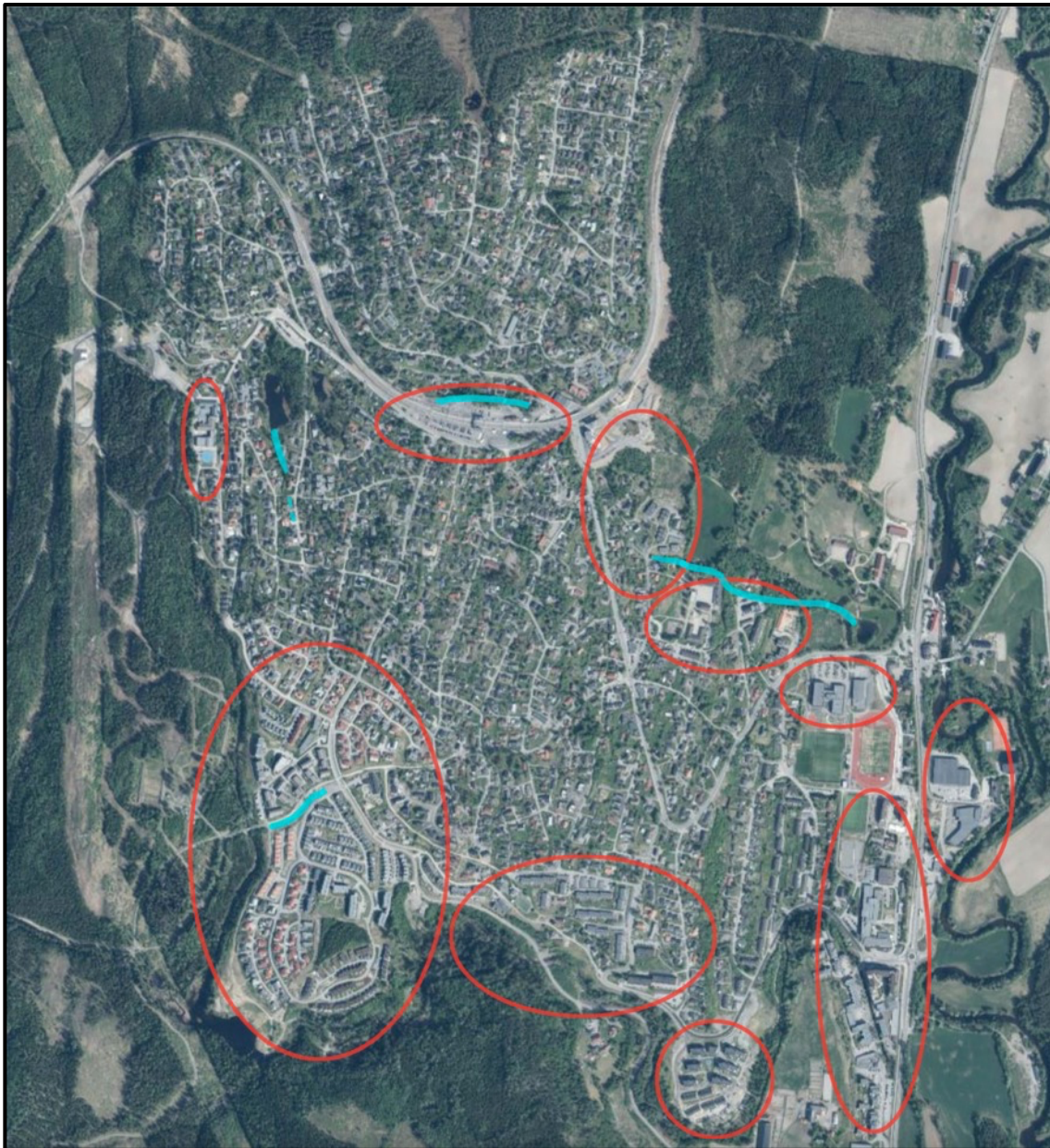
Figur 2. Flyfoto fra 2023. Vandringskorridorene langs og gjennom Vassøybekken og Rotnesbekken er i stor grad blitt lagt i rør (åpne deler er markert i blå). Større områder som særlig siden årtusenskiftet er bygget ut er markert med rød ellipser. Kilde: Norgebilder.no
