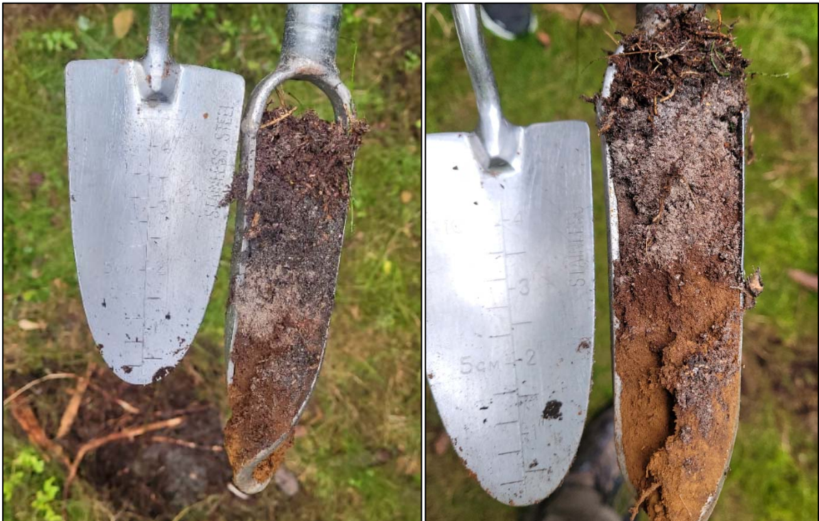
Figur 19. Podsol-profil fra BG1 t.v. og BG2 t.h. Profilet fra BG1 har et tykkere organisk lag enn BG2. Begge viser overgang fra utvasket grå sand til en jernrik/rustbrunt utfellingslag.
