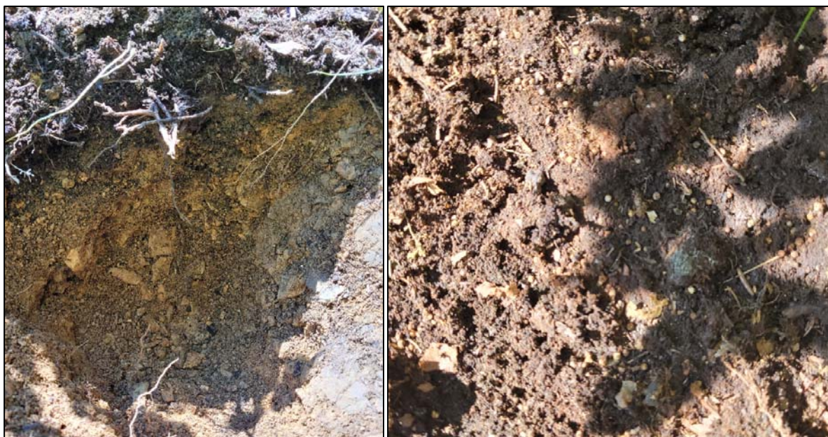
Figur 16. Massene ved HS404 består av et tynt lag av torvjord og underliggende lys sand og grus. I torvjorda var det mye synlig blyhagl.
